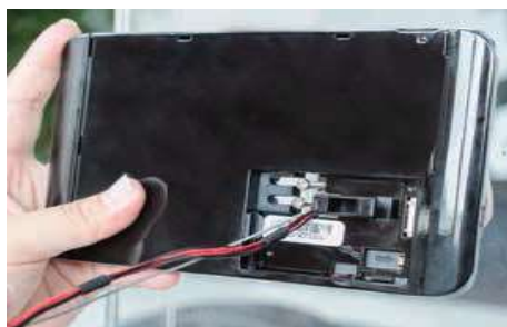
5. Far passare i fili e viti attraverso la parte interna
