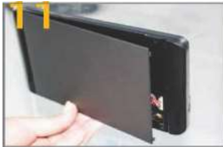
11. Chiudere il coperchio (come mostrato in figura, notare la direzione)
