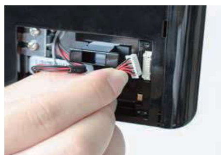
8. Allacciare le cinture di spina bianca sulla fessura bianca
