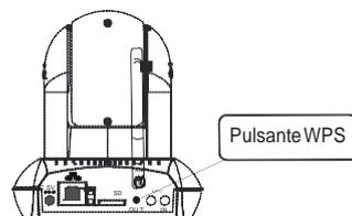
2. Entro 60 secondi, premere il pulsante WPS sul router wireless. Il pulsante WPS è di solito sulla parte anteriore o posteriore del router. Se non si è sicuri circa la funzione WPS del router, far riferimento alla Manuale utente del router.
