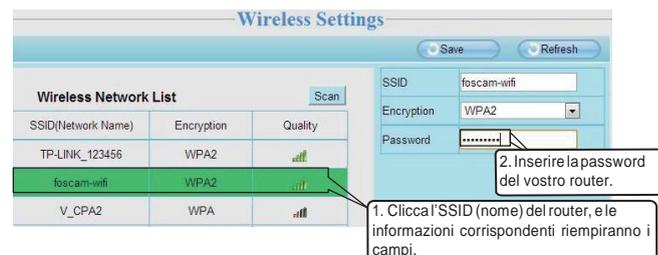
3. Cliccare sul pulsante Salva e scollegare il cavo di rete. Non spegnere la telecamera fino a quando non appaia nell'interfaccia dello Strumento della telecamera IP. Se la telecamera non venisse visualizzata, provare a scollegare il cavo di alimentazione della telecamera e ricollegarlo. Dovrebbe quindi connettersi automaticamente alla rete wireless.
