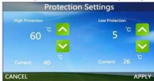
**Alta Protezione:** Utilizza un sensore esterno per sondare la temperatura del pavimento. Quando la temperatura è troppo alta, il sistema verrà chiuso automaticamente.
